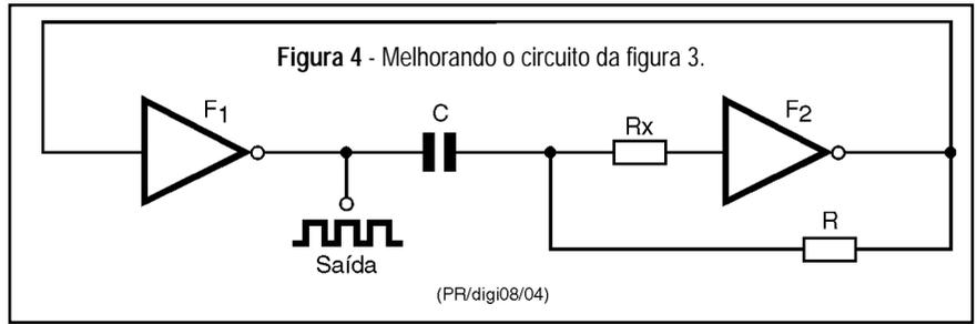
seguinte forma: quando o inversor F-2 está com a saída no nível alto, a saída de F-1 estará no nível baixo, o que faz com que o capacitor carregue via R. Quando a tensão em C atinge o valor que provoca a comutação de F-2, ele troca de estado e sua saída vai ao nível baixo. Nestas condições a saída de F-1 vai ao nível alto, o capacitor é "invertido" começando sua carga, mas com polaridade oposta até que novamente tenhamos o reconhecimento do nível de comutação e um novo ciclo se inicie.
