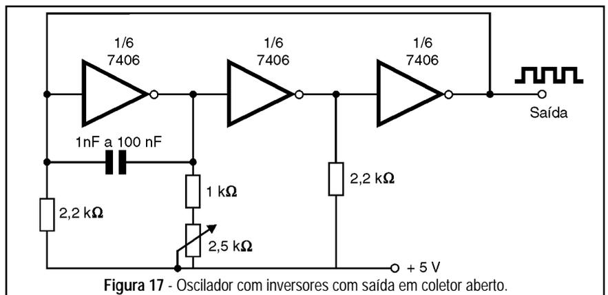
Figura 17 - Oscilador com inversores com saída em coletor aberto.
