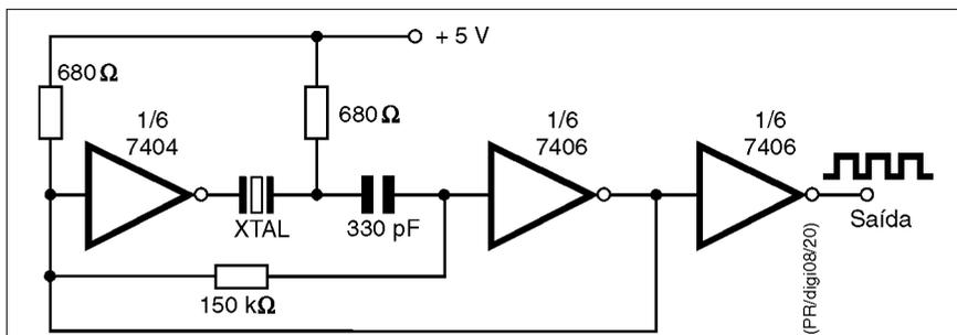
**Figura 20 - Oscilador controlado a cristal com inversores TTL.**
