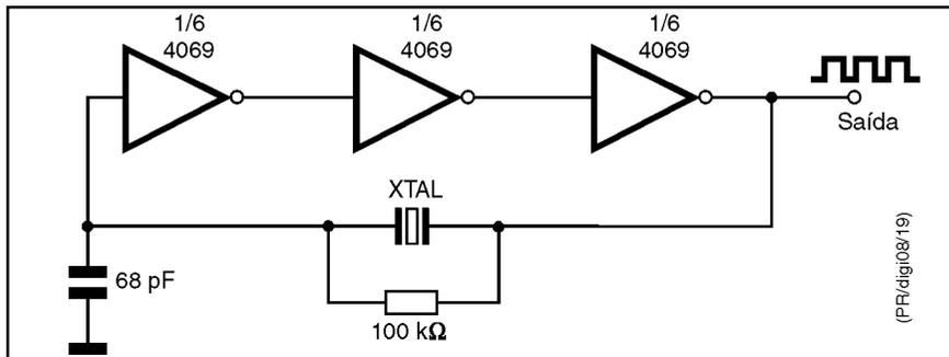
**Figura 19 - Oscilador CMOS a cristal com inversores CMOS.**
