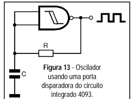
Figura 13 - Oscilador usando uma porta disparadora do circuito integrado 4093.
