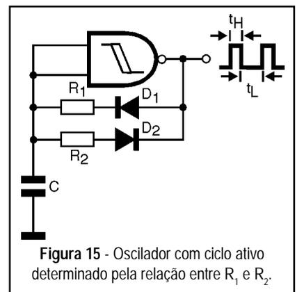
Figura 15 - Oscilador com ciclo ativo determinado pela relação entre  $R_1$  e  $R_2$ .
