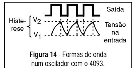
Figura 14 - Formas de onda num oscilador com o 4093.
