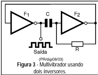
O leitor pode perceber então que o tempo de carga e descarga dos capacitores e portanto, das oscilações geradas por este circuito, dependem tanto dos valores dos capacitores como dos resistores de base através dos quais ocorrem as descargas.
