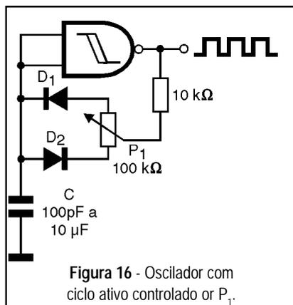
Figura 16 - Oscilador com ciclo ativo controlado por  $P_1$ .
