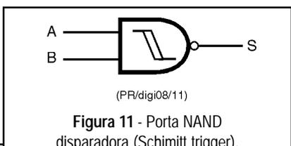
Um tipo de função lógica importante, que possui tempos reduzidos de comutação, é a formada por circuitos disparadores ou "triggers",
