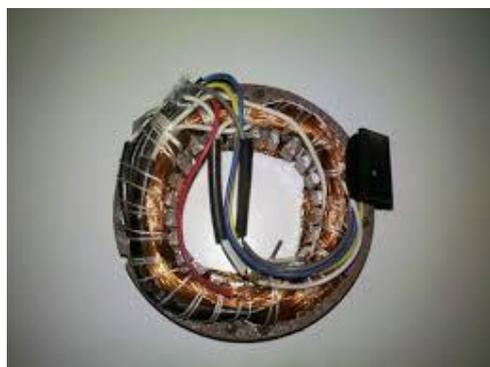
O bom nos ventiladores é que eles possuem uma proteção para que não queime, pois existe no emaranhado de fios do estator, um fusível térmico que sai para a chave de velocidade e liga-desliga.
