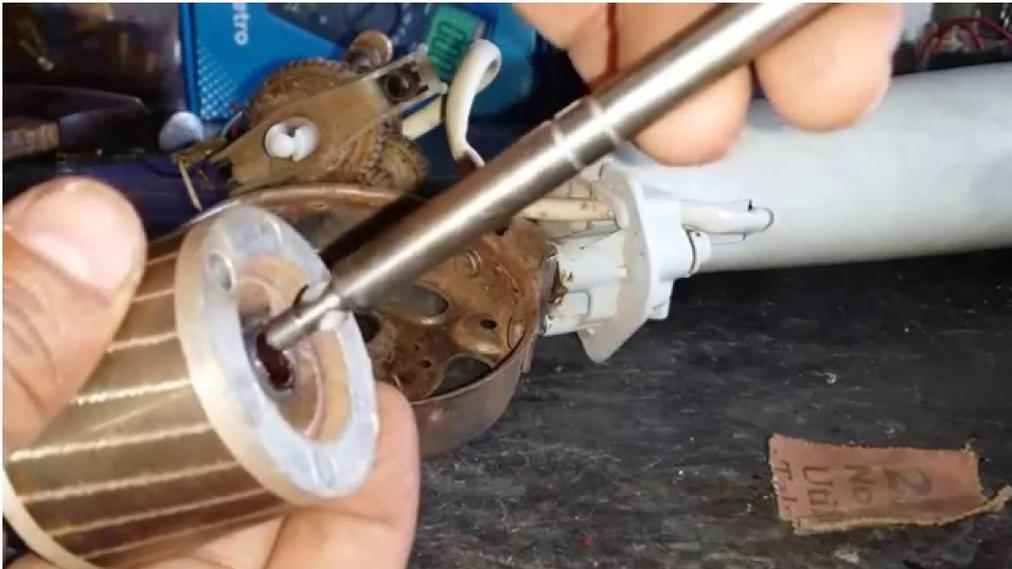
A bucha é encaixada na tampa do motor através de uma trava aranha. Você terá que retirar a trava e colocar a bucha nova e travar novamente muito bem.
