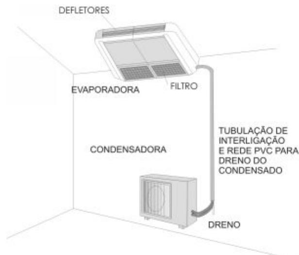
Figura 4.14 – Ilustração de um sistema split tipo piso-teto
