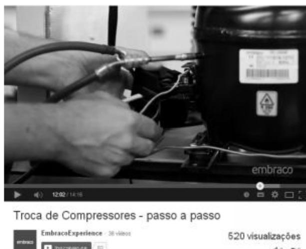
Figura 5.5- Procedimento correto para troca de compressores EMBRACO.
