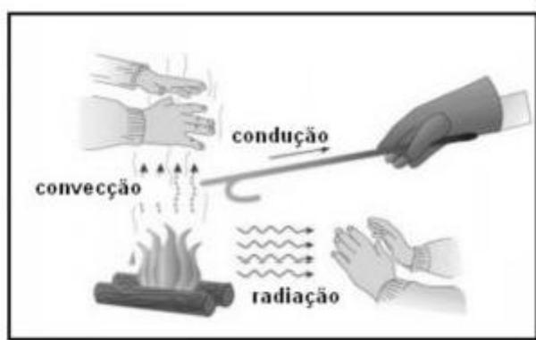
Figura 2.19- Modos de transferência de calor.
