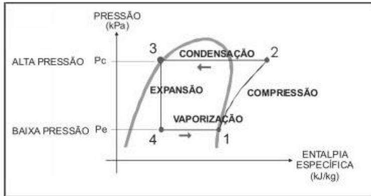
Figura 3.9 – Esquema do ciclo de compressão e diagrama pressão *versus* entalpia
