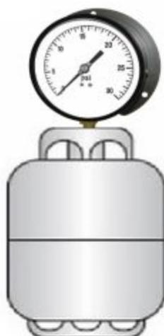
Figura 2.9- Ilustração da medição da pressão interna (cilindro vazio)
