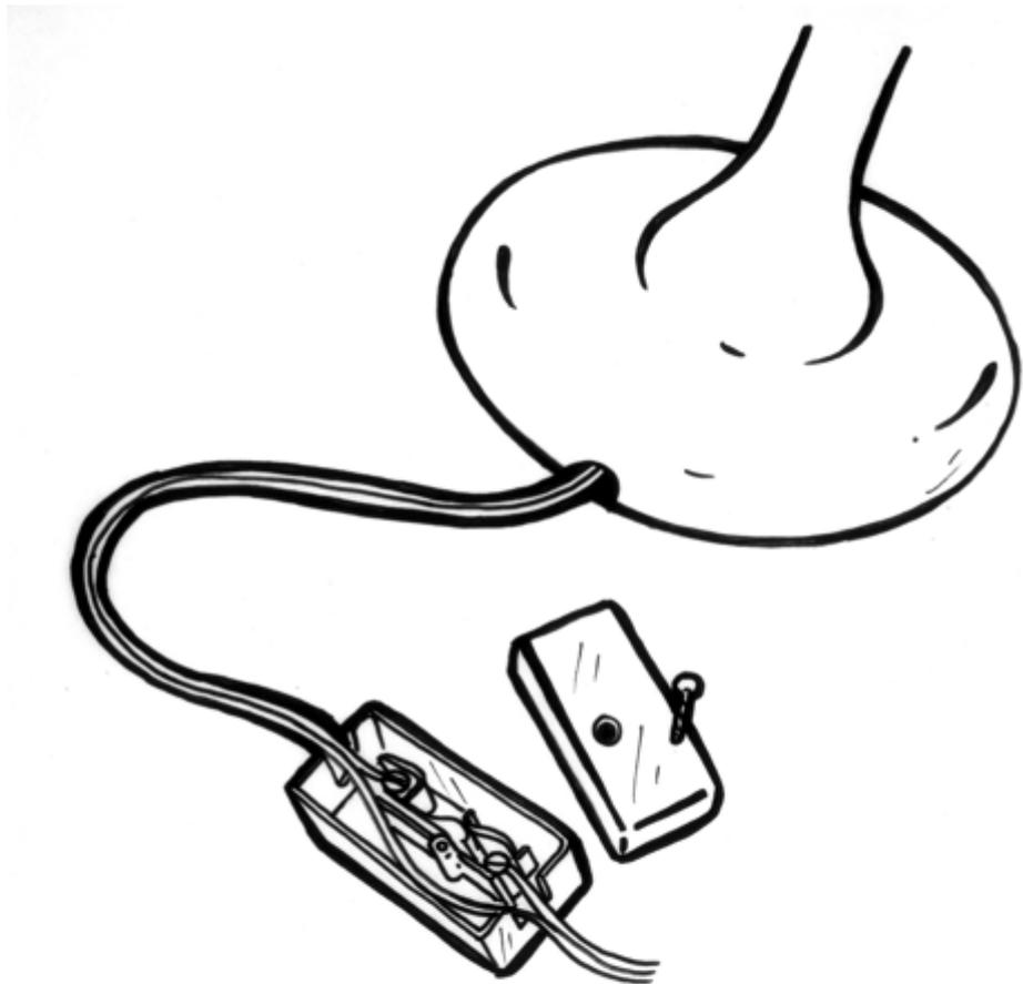
6. Depois de os parafusos com seus respectivos aros estarem encaixados nos orifícios do interruptor, aperte-os com a chave de fenda.
