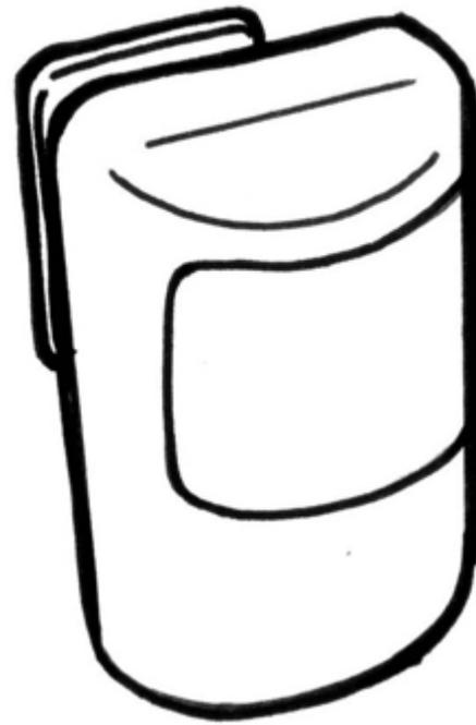
Ao instalar um sensor de presença, tenha cuidado para não o colocar em local muito ventilado e próximo de grandes plantas – caso contrário, ele poderá ser acionado repetidas vezes por tal movimento, gerando um gasto de energia elétrica desnecessário. Sua instalação requer o desligamento do interruptor convencional.
