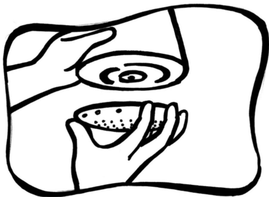
4. Em seguida, segure com uma mão a parte superior da ducha e, com a outra, puxe para baixo a alça da parte inferior, de modo a retirar essa peça.
