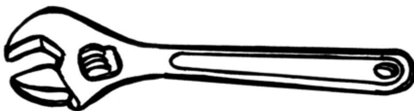
Existem modelos com bicos fixos ou ajustáveis, sendo estes últimos mais indicados para quem está montando um kit de ferramentas. Sua principal função é ajudar o usuário a apertar parafusos e porcas de formato hexagonal.
