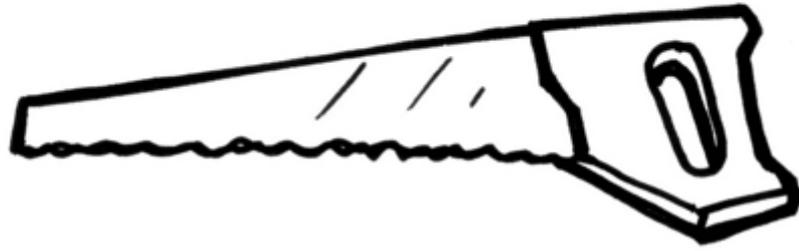
Utilizados para cortar superfícies metálicas ou de madeira, os serrotes manuais são mais adequados para cortar peças pequenas, que não sejam maciças nem muito espessas. Para peças maiores e mais encorpadas, o ideal é usar uma serra elétrica do tipo tico-tico. Modelos que vêm com a serra protegida são mais seguros para guardar e transportar.
