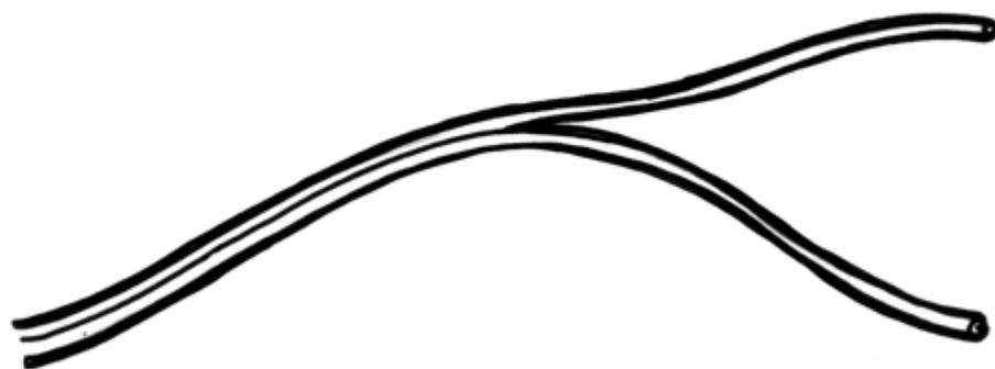
4. Com um descascador de fios (ou com o estilete, se você não tiver essa ferramenta), descasque as pontas desses fios separados.
