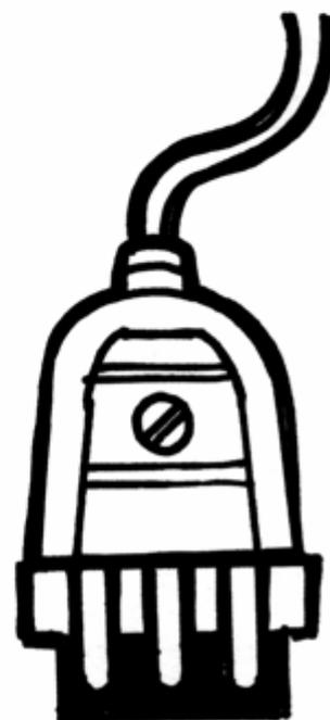
O novo sistema ainda elimina o risco de sobrecarga em aparelhos elétricos, por conta de um princípio simples: todos os plugues e tomadas deverão operar apenas em duas versões de correntes: 10 A ou 20 A. Como tomadas e aparelhos que operam com 20 A terão plugues de diâmetro ligeiramente superior aos de 10 A, será impossível conectar um aparelho de 20 A em tomada que tenha corrente de 10 A. Os circuitos ficarão, dessa forma, protegidos contra eventuais sobrecargas.
