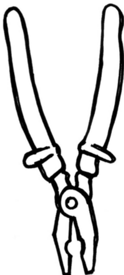
É o alicate mais completo, sendo muito utilizado em vários tipos de conserto. Essa ferramenta tem uma região própria para corte, capaz de cortar fios e arames de cobre, latão, alumínio, plástico, bronze, aço etc. Se houver a intenção de apenas moldar ou dobrar tais fios, também é possível fazê-lo com esse alicate. A ferramenta serve, ainda, para segurar com firmeza peças resistentes e de formatos diversos (achatadas, ovais,
