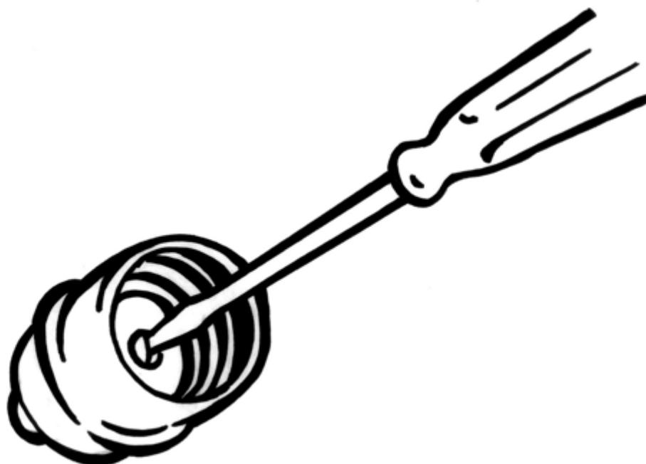
2. Desatarraxe o soquete e passe o fio paralelo pelo orifício existente na
