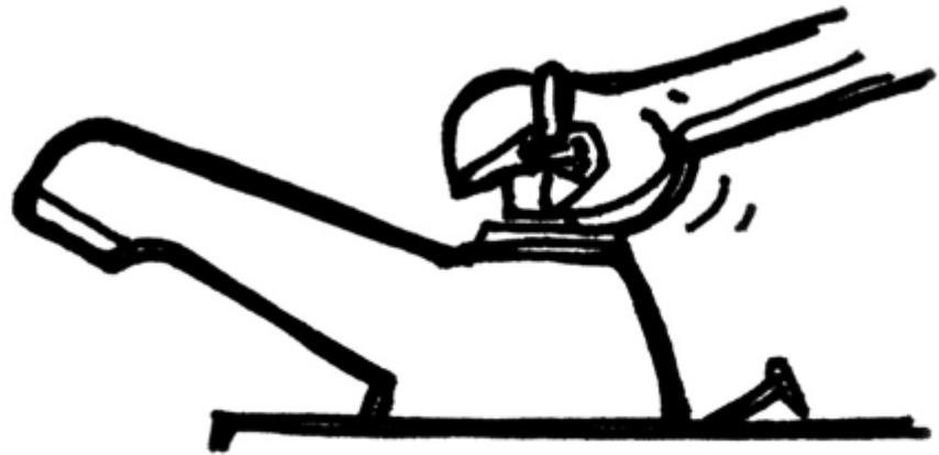
5. Substitua a peça desgastada por uma nova, que pode ser plástica ou de material equivalente ao original. Em seguida, remonte o corpo e o volante da torneira.
