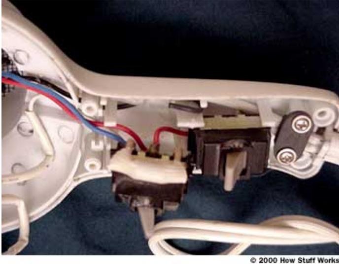
Dois interruptores controlam quando e a quantidade de corrente que passa pelo circuito do secador. Um (esquerda) regula a velocidade do motor (e assim o fluxo de ar) e o outro (direita) liga e desliga o secador.
