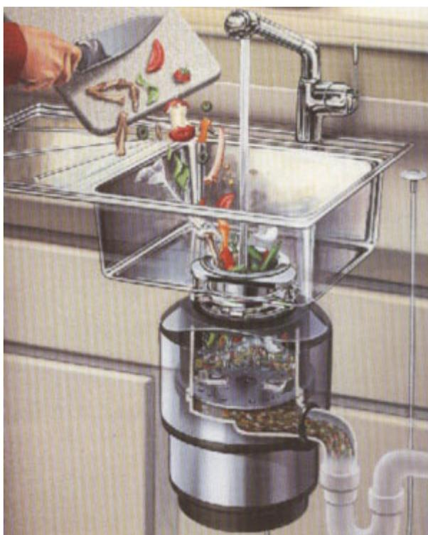
Um triturador de lixo é um eletrodoméstico com motor. O motor gira um volante ao qual se prendem palhetas. Essas palhetas rotatórias batem e cortam resíduos alimentares dentro da câmara repetidas vezes, triturando-os em partículas pequenas que podem ser eliminadas pelo cano para o sistema séptico.
