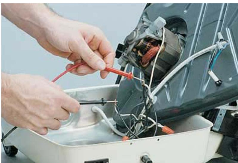
***Teste as escovas do motor do aspirador do tipo vassoura com um multímetro se você suspeita de defeito no motor***
