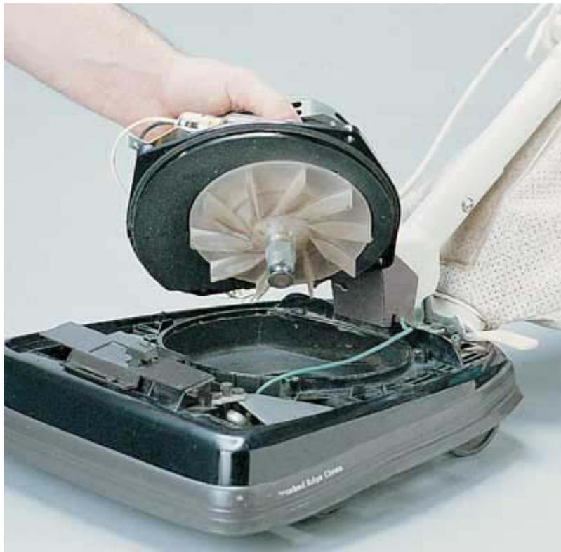
**Manutenção do motor e da ventoinha de um aspirador do tipo vassoura**
