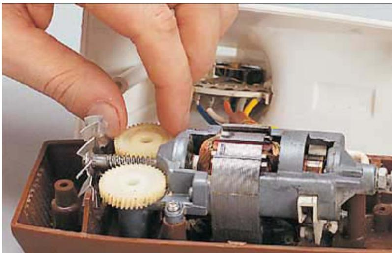
**Inspeccione e lubrifique as engrenagens; tome cuidado para que o excesso de lubrificante não chegue ao motor nem a qualquer componente elétrico.**
