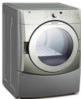
Uma secadora é simplesmente um tambor grande no qual a roupa molhada é colocada. Um motor com polias, conectado por uma série de correias, gira o tambor. Ar aquecido por um aquecedor a gás ou elétrico é soprado através do tambor para secar a roupa. A temperatura e velocidade do tambor são controladas por uma série de termostatos operados por um timer no painel de controle da secadora.
