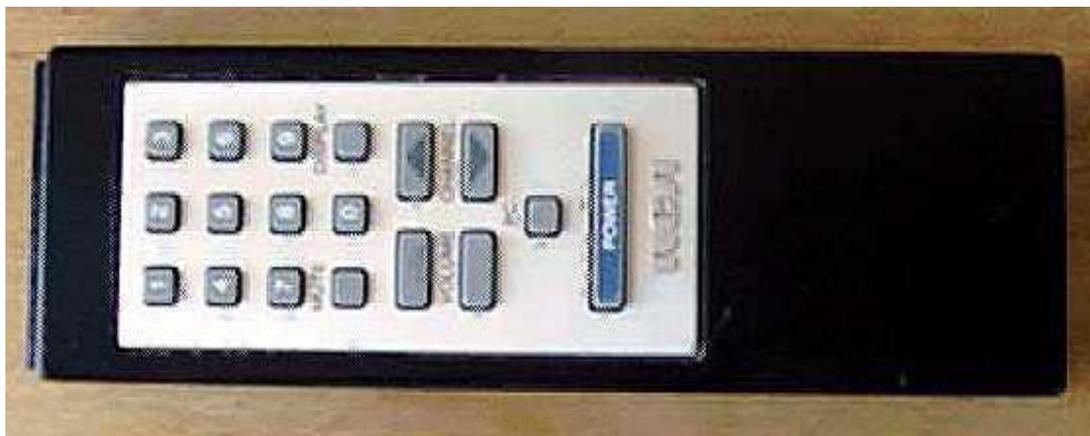
Ao pressionar uma tecla do controle, o pressionamento é traduzido em sinais de luz infravermelha que são recebidos pela TV. Quando você remove a tampa traseira do controle, pode ver que há somente uma parte visível: uma placa de circuito impresso que contém a parte eletrônica e os contatos da bateria.
