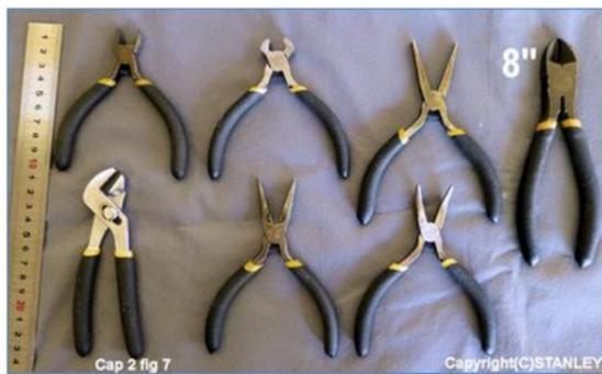
Figura 9 - Mini alicates. Estes são os que uso. Pela cor dá para identificar os mais usados. Veja o tamanho comparado com um alicate de corte diagonal de 8".
