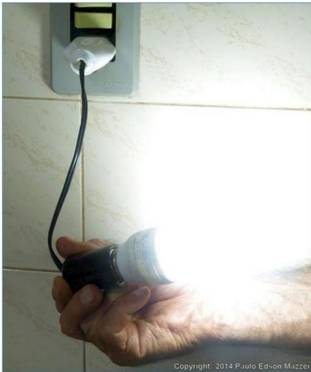
Figura 48 - Testador de tomadas em ação.
