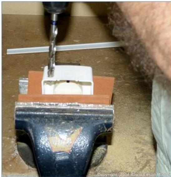
Figura 94 - Prender a caixinha para fazer o furo para o cabo PP.
