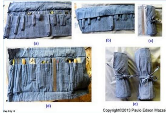
Figura 18 - Envelope de tecido. Em (a) aberto, para ferramentas usadas em eletricidade. Em (b) fechando e em (c) fechado e amarrado. Para ferramentas mais pesadas e maiores, foi feito um envelope um pouco maior, como mostrado em (d), para ferramentas como limas, serra, martelo, etc. Em (e) os dois envelopes de tecido fechados e prontos para entrar em alguma bolsa ou sacola.
