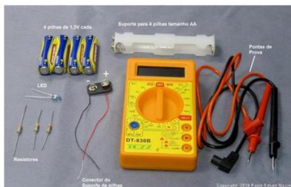
Figura 134 - Componentes necessários para experiência em medição de corrente CC.
