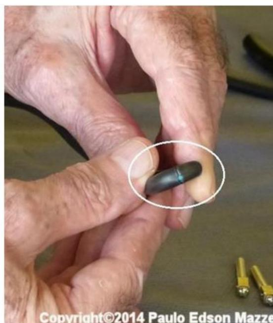
Figura 30 - Dobra do cabo para finalizar o corte da capa.
