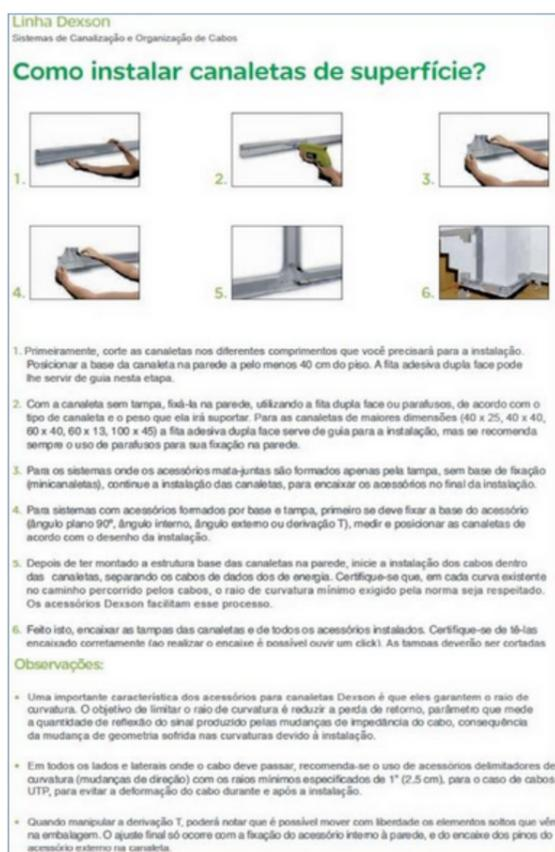
Figura 91 - Como instalar canaletas de superfície. Copyright ©2014 Dexson - Schneider Electric.
