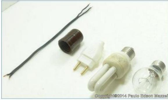
Figura 46 - Material para o testador de tomadas.
