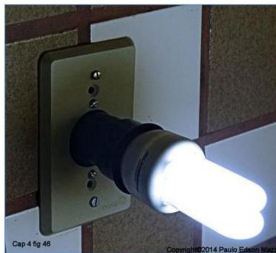
Figura 49 - Testador de tomadas com bocal e plugue já acoplado.
