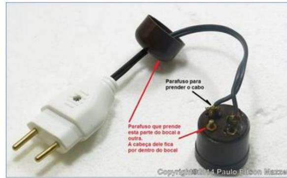
Figura 47 - Prendendo os condutores do cabo aos terminais do bocal.
