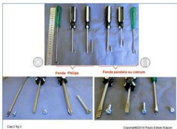
Figura 4 - Chaves de fenda usadas nos reparos do dia a dia. Note os comprimentos delas comparando-as com a escala de aço.
