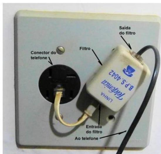
Figura 110 - Conexão de telefone.
