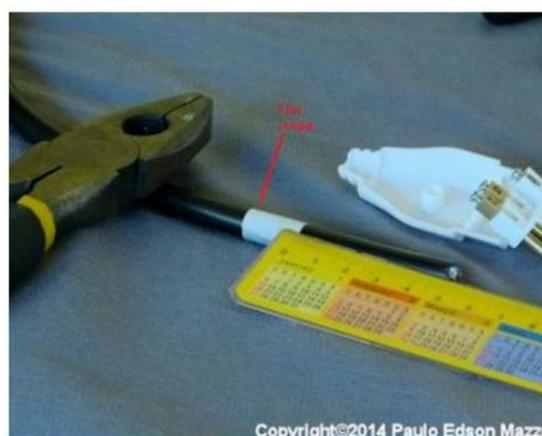
Figura 28 - Use um pedaço de fita crepe para marcar o lugar do corte do cabo.
