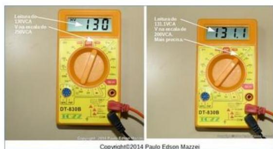
Figura 132 - Medições de tensão CA.
