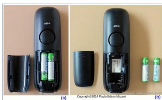
Figura 116 - Ramal ou extensão de telefone se fio alimentado por duas pilhas recarregáveis de 1,2V (a) e Pilhas fora do alojamento das mesmas (b).
