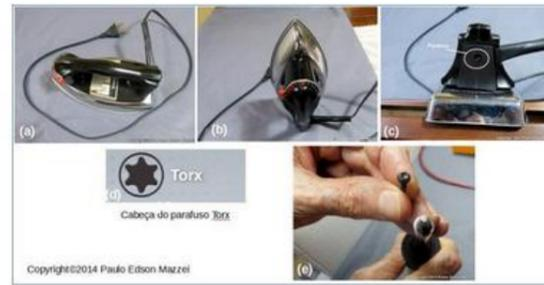
Figura 143 - Como abrir o ferro e parafuso modelo "Torx".
