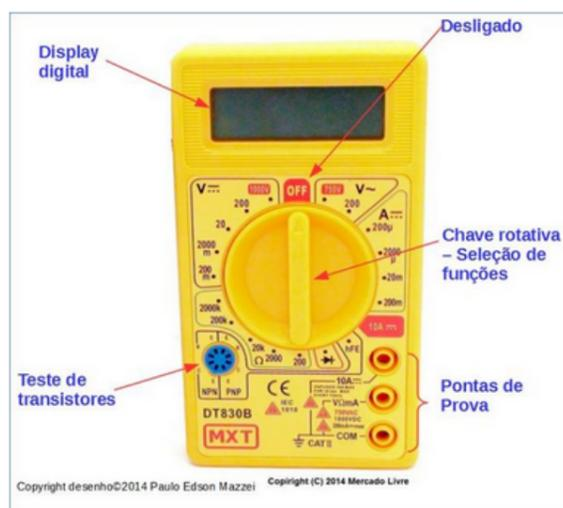
Figura 123 - Multímetro digital e suas escalas.
