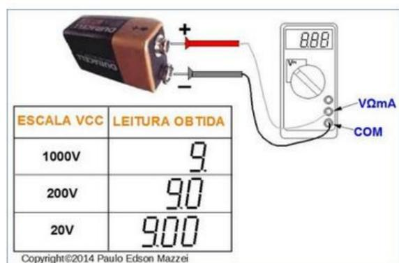
Figura 129 - Medição de tensão CC.
