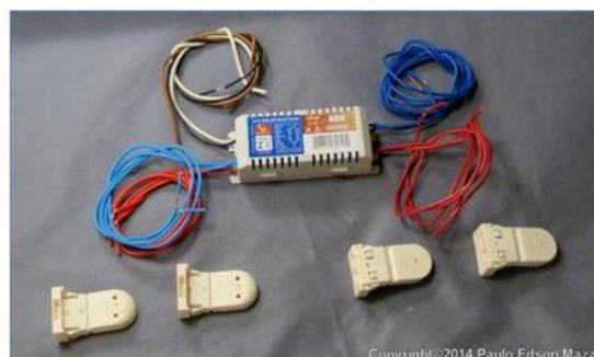
Figura 78 - Reator eletrônico e soquetes das lâmpadas.
