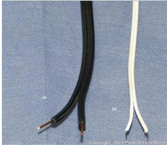
**Figura 112 - Cabos telefônicos. (a) externo e (b) interno.**
