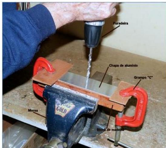
Figura 14 - Maneira correta de furar uma lâmina de alumínio ou outro metal.
