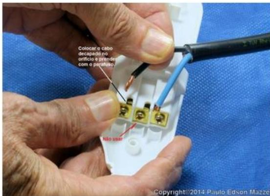
Figura 41 - Inserindo os cabos nos terminais da tomada.
