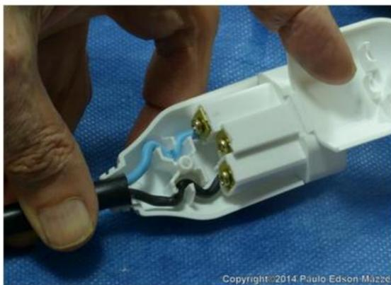
Figura 42 - Tomada com os cabos presos e travados.
