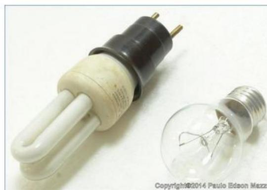
Figura 45 - Testador de tomadas montado. Pode ser usada uma lâmpada compacta de baixo consumo ou uma lâmpada incandescente.
