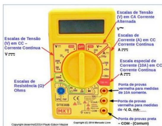
Figura 124 - Escalas do multímetro digital simples.
